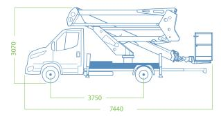
OUTRIGGERS Vertical H+H WORKING HEIGHT 19.6 m BASKET HEIGHT 17,6 m MAX OUTREACH 9 m BASKET LOAD CAPACITY 230kg BASKET SIZE 1400 x 700 x 1100 mm CONTROLS Electric TURRET ROTATION
